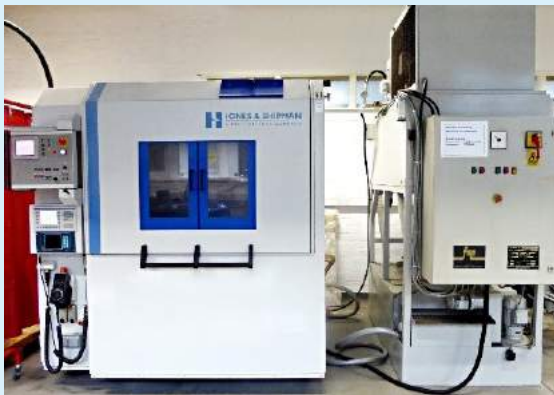
1 ère Rectifieuse dans le monde à haute vitesse avec vibration 1 st high-speed grinding machine in the world with vibration
