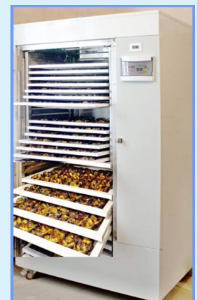
Machine pour séchage des produits agricoles aux rayons infrarouges Machine for drying agricultural products with infrared rays
